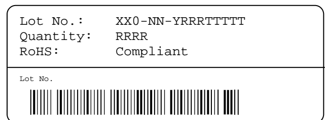
图 19: 胶盘上的第一个标签: XX=传感器型号 (11 即 SHT11), NN=芯片版本 (04表示V4), Y=年份的数字标识, RRR=胶盘上的传感器数量除以10 (通常为200或2000), TTTTT=追踪代码。
